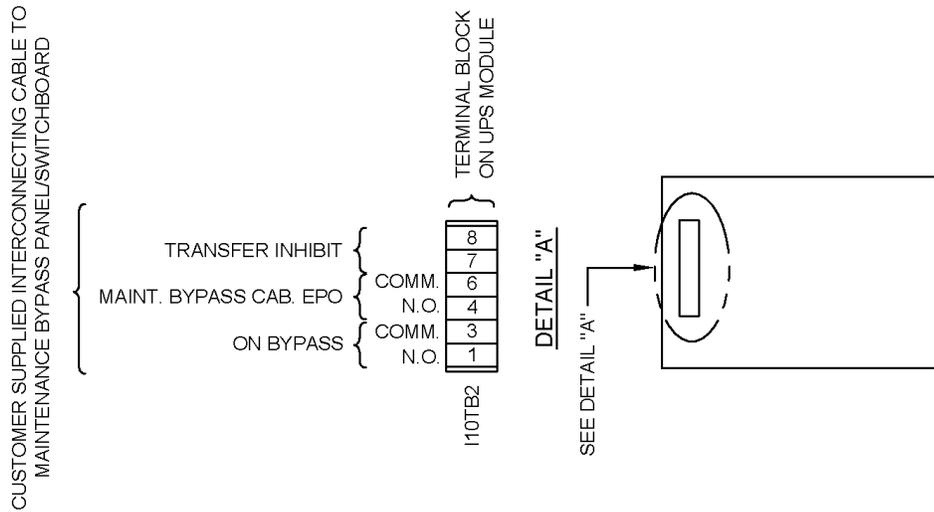
MAINTENANCE BYPASS INTERLOCK BOARD
