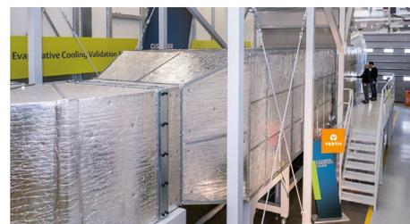
L'area dedicata ai test di Liebert EFC, unità di condizionamento di Vertiv ad alta efficienza con freecooling evaporativo indiretto. I parametri di test includono un carico IT fino a 450 kW e un flusso d'aria fino a 120,000 m<sup>3</sup> all'ora con qualsiasi temperatura esterna richiesta per simulare condizioni ambientali tipiche della regione EMEA.
