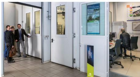
Questo laboratorio risponde alla sempre maggiore domanda di witness test e omologazione prodotti speciali per clienti. Dotato di una sala climatica altamente automatizzata è in grado di bilanciare un carico termico sino a 200 kW e di simulare un ambiente di prova con escursione termica da 0°C a 60°C.
