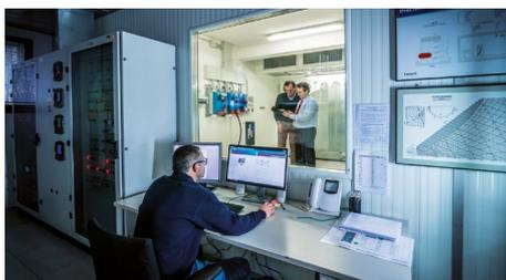
Appositamente studiato per testare le unità floor mountig, è in grado di bilanciare un carico termico sino a 150 kW, con una temperatura dell'aria tra 0°C e 60°C.
