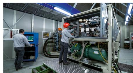
L'area di prova dei gruppi refrigeratori ad acqua della serie Freecooling Chillers e freecooling chiller adiabatici è in grado di bilanciare un carico termico sino a 1.600 kW con una temperatura dell'aria all'ingresso della unità compresa fra i 20°C e i 50°C ed il set point dell'acqua del chiller fra i 5°C e i 20°C.
