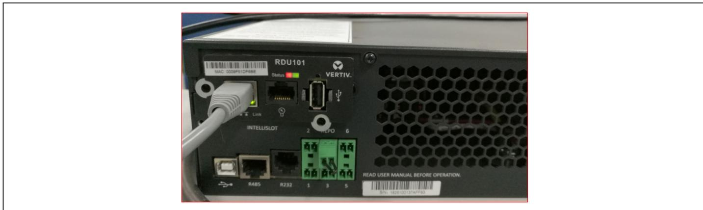
2. Conecte um cabo de rede à porta Ethernet RJ-45 da placa RDU101. Para o local da placa/conexão, consulte a descrição apropriada do painel traseiro para o seu modelo de UPS em [Painéis traseiros](#) na [página 3](#).
