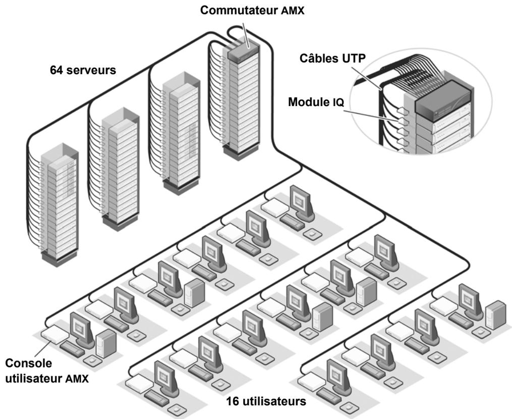
Figure 1.1 : Configuration classique du système de commutation AMX
