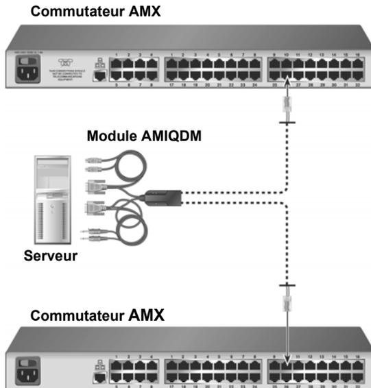
Figure 2.10 : Connectivité à voie double par module AMIQDM
