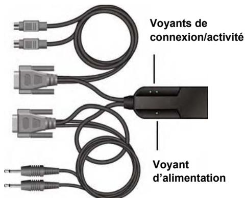
**Figure 2.17 : Modules IQ avec voyants (module AMIQDM illustré)**
