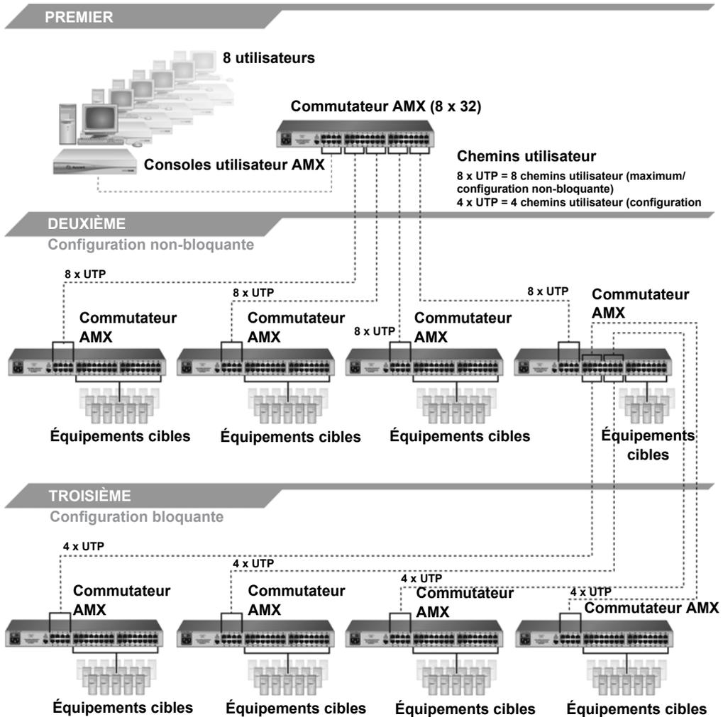
Figure 2.12 : Système de commutation AMX en cascade, configurations combinées
