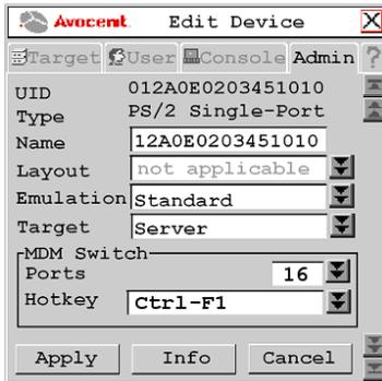
Figure 3.28 : Écran Edit Device (configuration en cascade continue)
