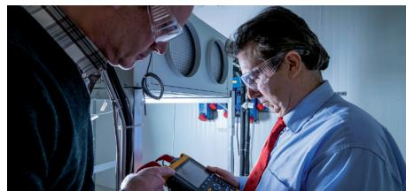
Conçu pour les climatiseurs du secteur des télécoms, le laboratoire de validation de Recherche et Développement n°2 regroupe deux espaces de tests distincts : l'un simule des conditions ambiantes internes comprises entre 0 °C et 60 °C et l'autre des conditions ambiantes externes allant de -32 °C à 60 °C. Cette zone de validation peut équilibrer une charge thermique jusqu'à 100 kW (50 kW dans chaque salle).
