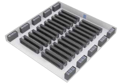
Using Liebert CW 440kW
