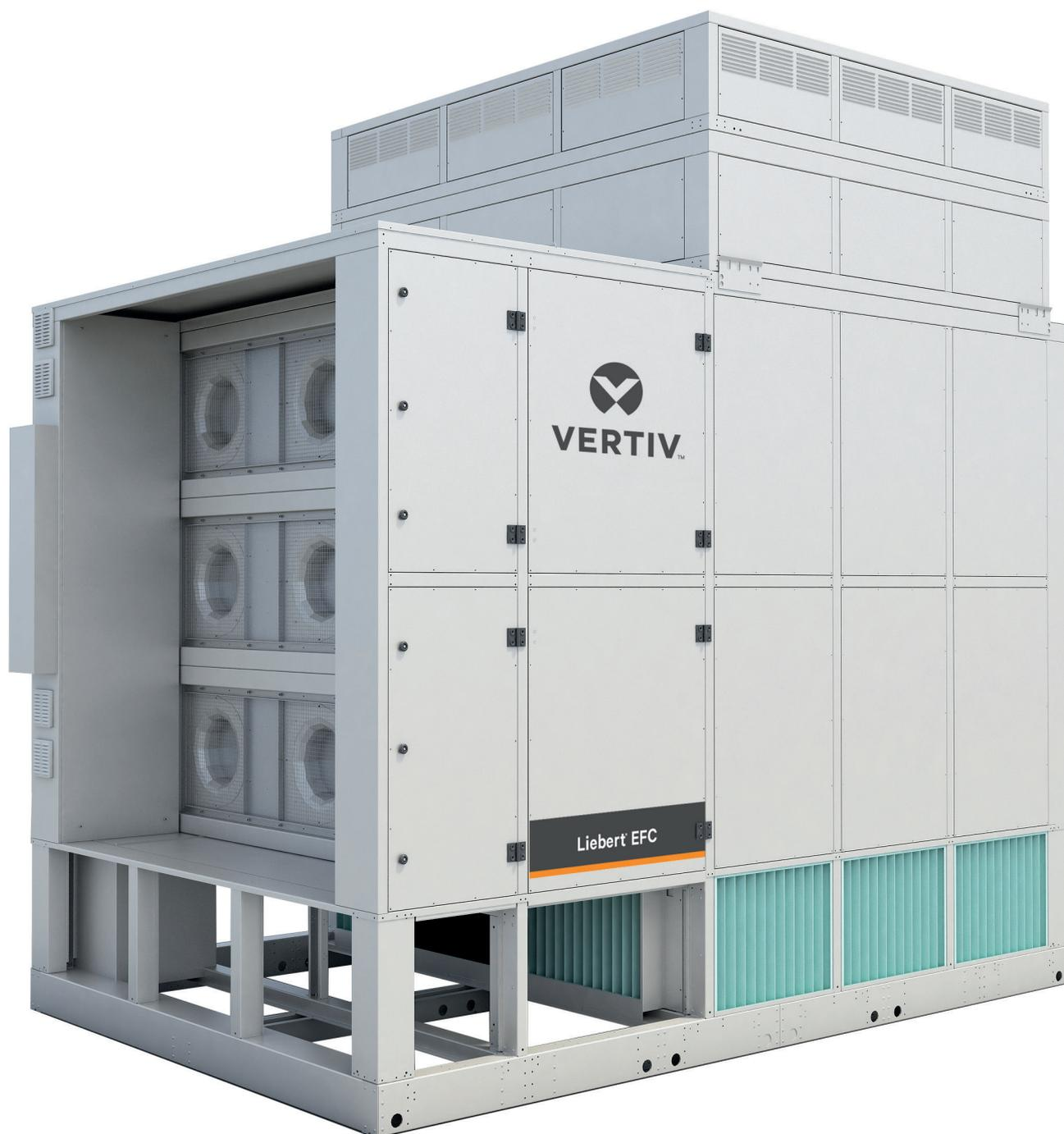
Il sistema evaporativo dispone di una pompa interna dedicata che eroga l'acqua necessaria. L'acqua viene spruzzata attraverso speciali ugelli sullo scambiatore di calore dove evapora umidificando e raffreddando l'aria.
