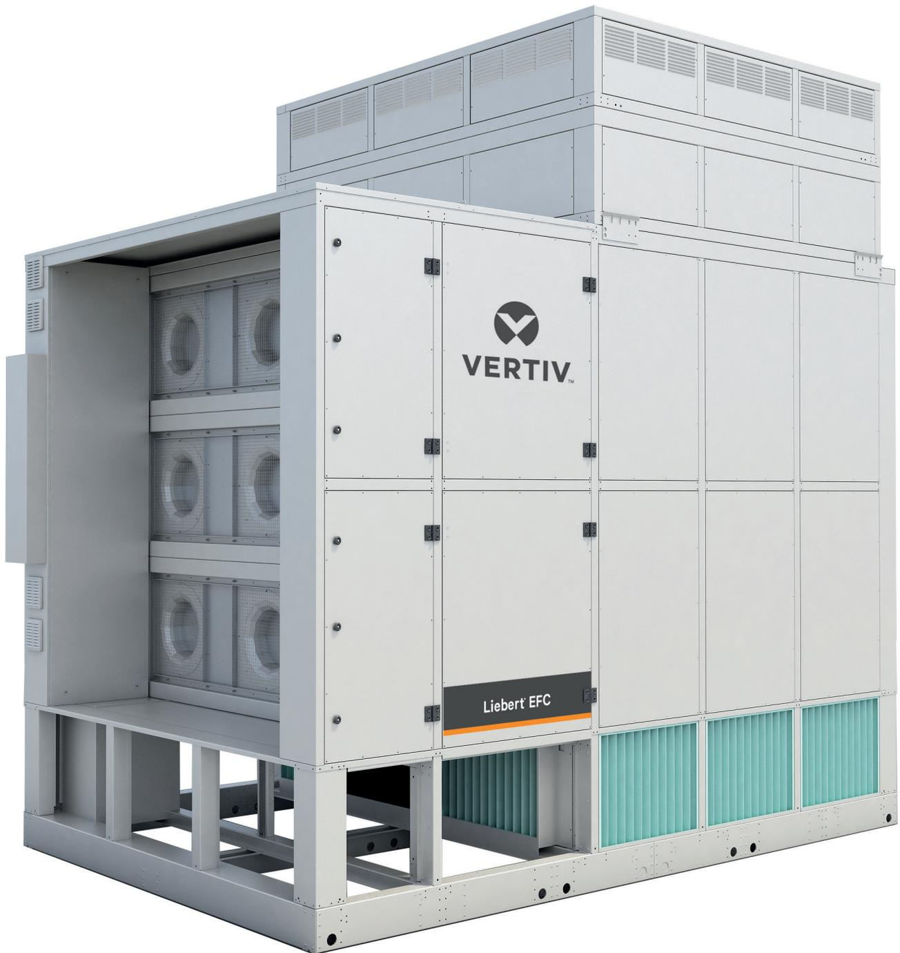
Le système d'évaporation dispose d'une pompe intégrée dédiée qui fournit la quantité d'eau nécessaire. L'eau est pulvérisée par des buses spéciales sur l'échangeur de chaleur et s'évapore, ce qui humidifie et refroidit l'air.
