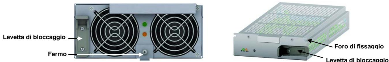
3. Per estrarre i moduli di potenza, caricabatteria e batteria:
