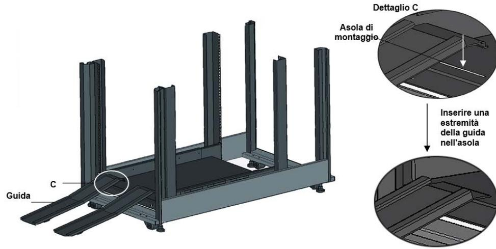
**Figura 17: Installazione delle guide**
