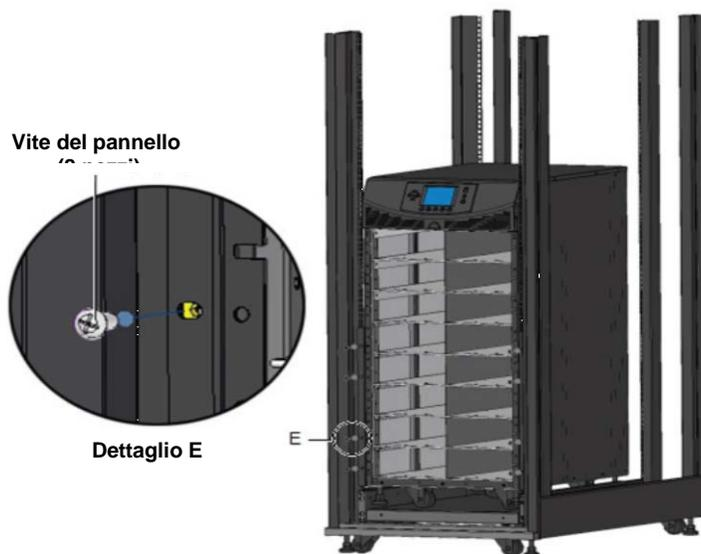
8. Usare quattro viti per installare la piastrina metallica (accessorio nel kit di montaggio in rack) nella posizione corrispondente sulla parte anteriore inferiore del telaio dell'UPS
