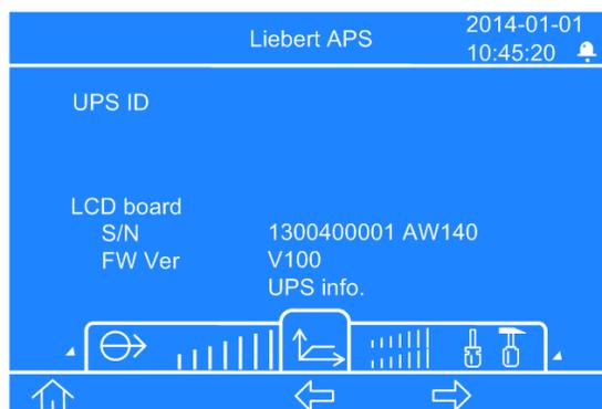
La schermata delle informazioni dell'UPS visualizza ID UPS (nome impostato dall'utente), numero di serie e versione software del modulo LCD, modulo di monitoraggio del sistema, modulo di controllo del sistema, modulo caricabatteria, modulo di potenza e modulo batteria (se i moduli sono installati e se sono online).
