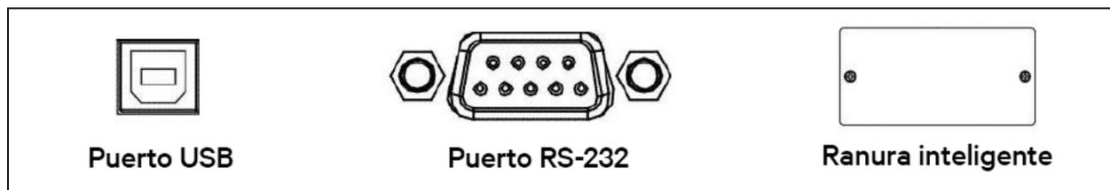
Para permitir el inicio/apagado del UPS y el monitoreo de estado en modo autónomo, conecte uno de los extremos del cable de comunicación al puerto USB/RS-232 y el otro puerto de comunicación a su PC. Si instala el software de monitoreo, podrá programar el inicio/apagado y el monitoreo de estado del UPS a través de su PC.
