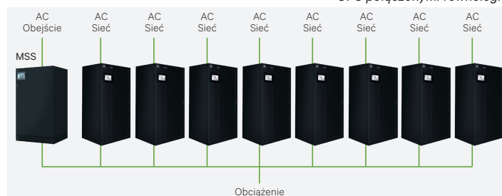
Scentralizowana konfiguracja równoległa Liebert EXL S1 z MSS i 8 jednostkami UPS połączonymi równoległe
