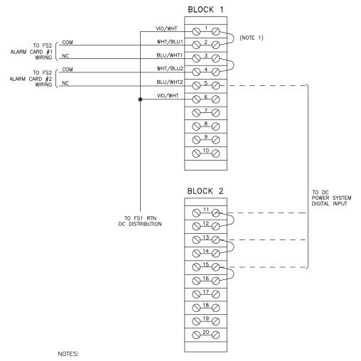
1. INSTALL LINK ON THE FACTORY WIRING SIDE OF THE TERMINAL.
