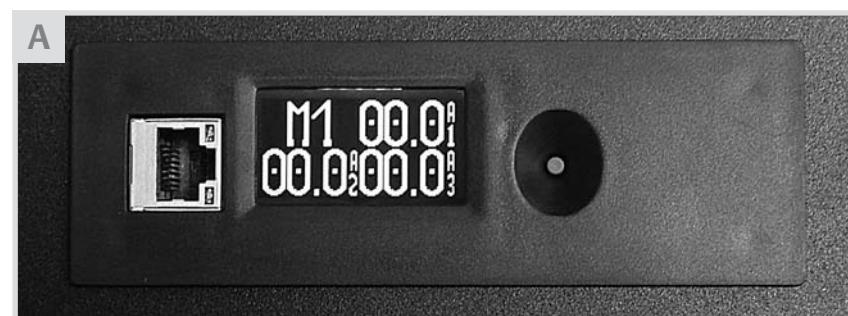
Das Gedrückthalten der Taste während des Einschaltens des Strommess-Moduls baut eine temporäre Verbindung zum DHCP-Netzwerk auf. Der DHCP-Server weist dem Strommess-Modul eine IP-Adresse zu und stellt die Verbindung zum Netzwerk her. Bei einem Zurücksetzen des Strommess-Moduls oder einer Unterbrechung der Stromversorgung verliert das Strommess-Modul diese temporäre DHCP-Einstellung.
