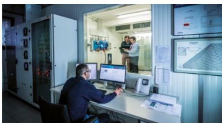
La zone d'essais de Recherche & Développement N°1 a été spécifiquement pensée pour tester les unités périphériques ; elle peut faire le bilan d'une charge thermique jusqu'à 150 kW avec une température ambiante comprise entre 0 °C et 60 °C.
