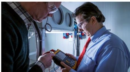
Conçue pour des conditionneurs du domaine des Télécoms, la zone d'essais de Recherche & Développement N°2 regroupe deux chambres d'essais distinctes : l'une simule des conditions ambiantes internes entre 0 °C et 60 °C et l'autre simule des conditions ambiantes extérieures de -32 °C à 60 °C. Cette zone d'essais peut faire le bilan d'une charge thermique jusqu'à 100 kW (50 kW dans chaque chambre).
