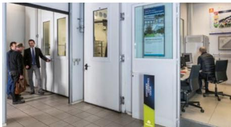
La zone d'essais d'unités périphériques répond aux exigences croissantes des essais usine et des agréments de produits spécifiques. Équipée d'une chambre d'essais fortement automatisée, cette zone d'essais peut faire le bilan d'une charge thermique jusqu'à 200 kW et peut simuler un environnement de test sur une plage de température de 0 °C à 60 °C.
