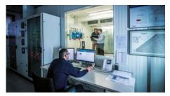
La zona de validación de Investigación y Desarrollo n.º 1 ha sido diseñada específicamente para la ejecución de pruebas de unidades de montaje en el suelo y tiene capacidad para equilibrar una carga térmica de hasta 150 kW con una temperatura del aire de la cámara de entre 0 y 60 °C.
