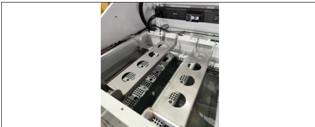
Abbildung 7.6 Installieren der Führungsschiene
