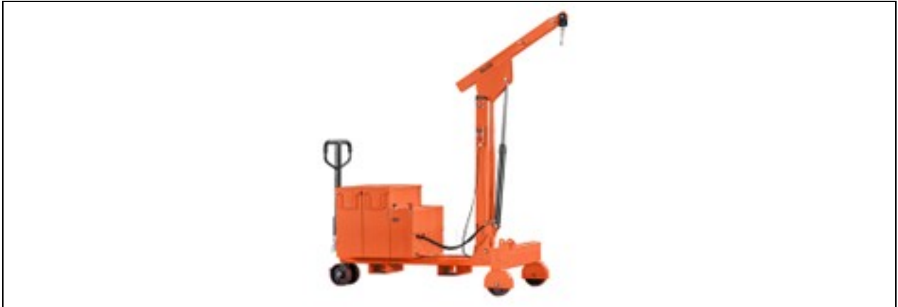
Abbildung 7.12 Kran mit einem Ausleger
