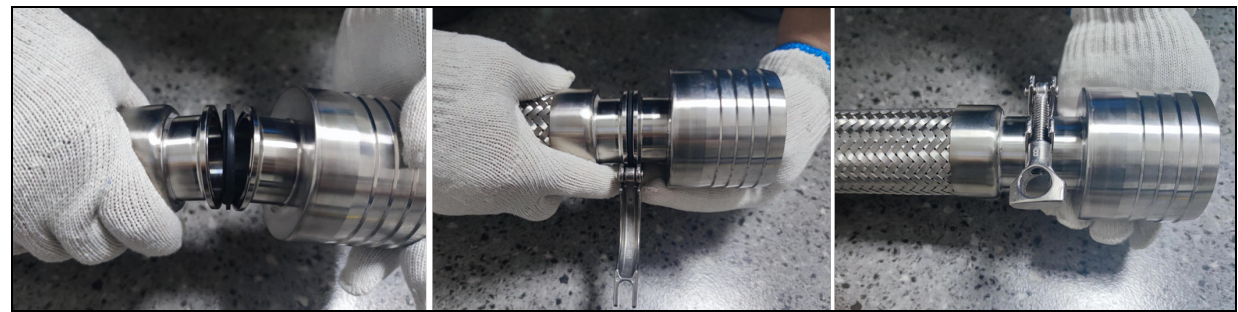
Abbildung 4.15 Verbinden der Rillenschelle
