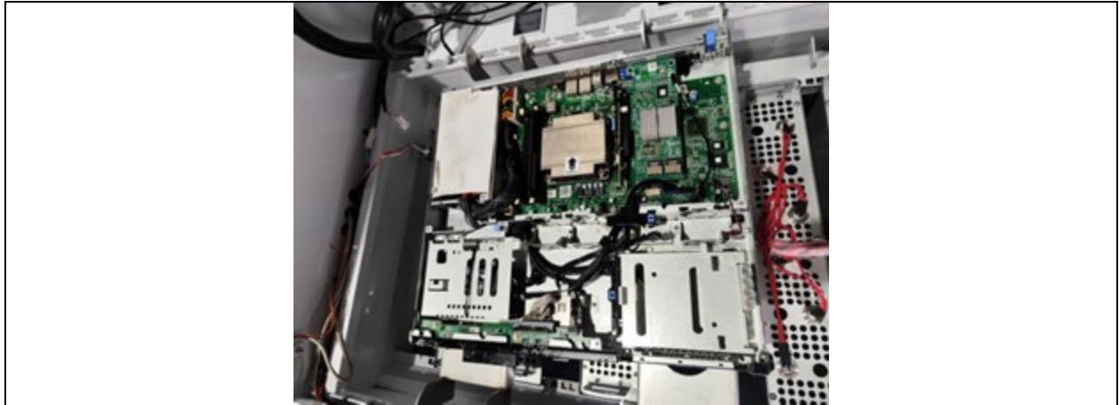
Abbildung 7.9 Aufsetzen des Servers auf der Führungsschiene
