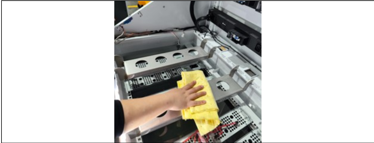
Abbildung 7.10 Abwischen der Führungsschiene
