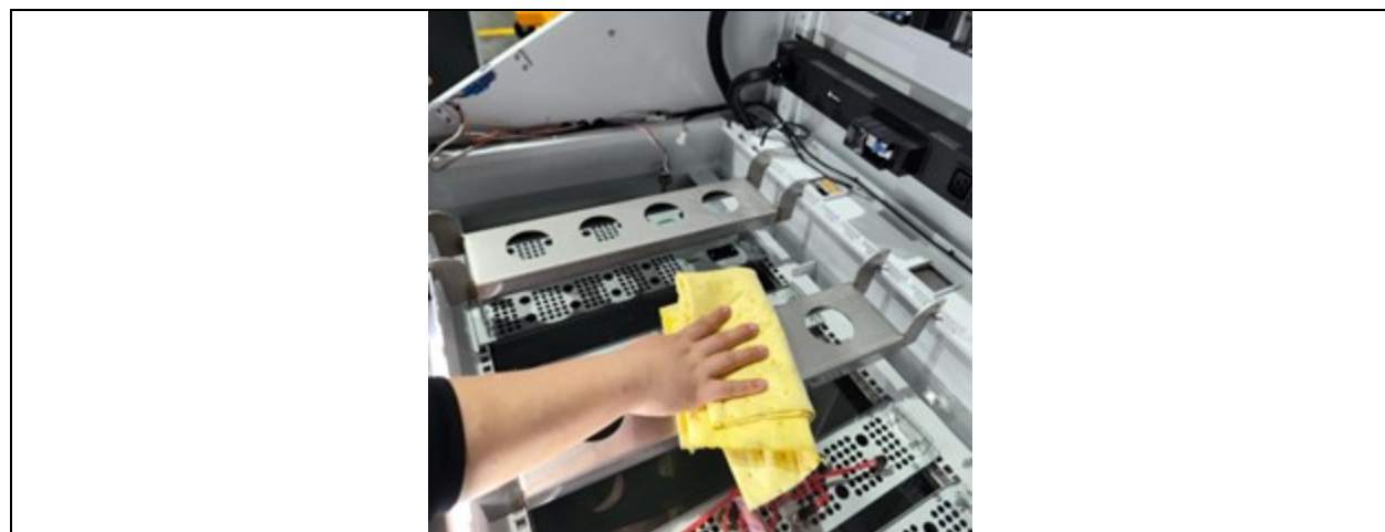
Figure 7.10 Nettoyage du rail de guidage
