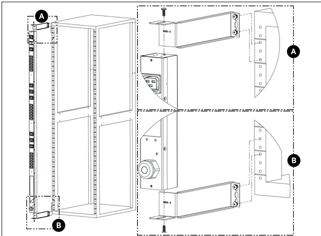
Figura 3.9 Suporte de montagem embutido
