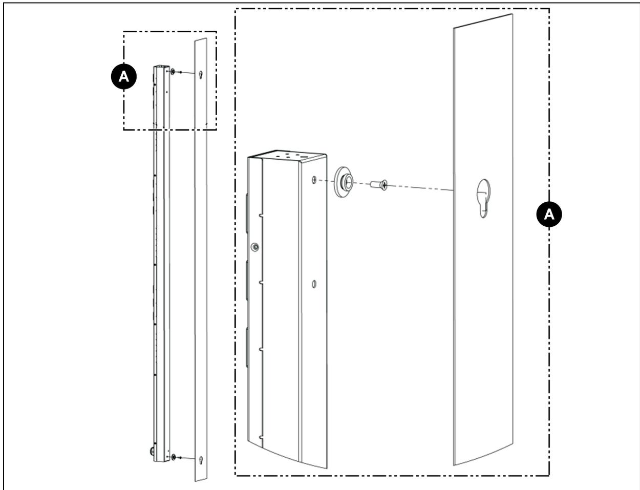
Figura 3.5 Suportes de comprimento completo sem ferramentas
