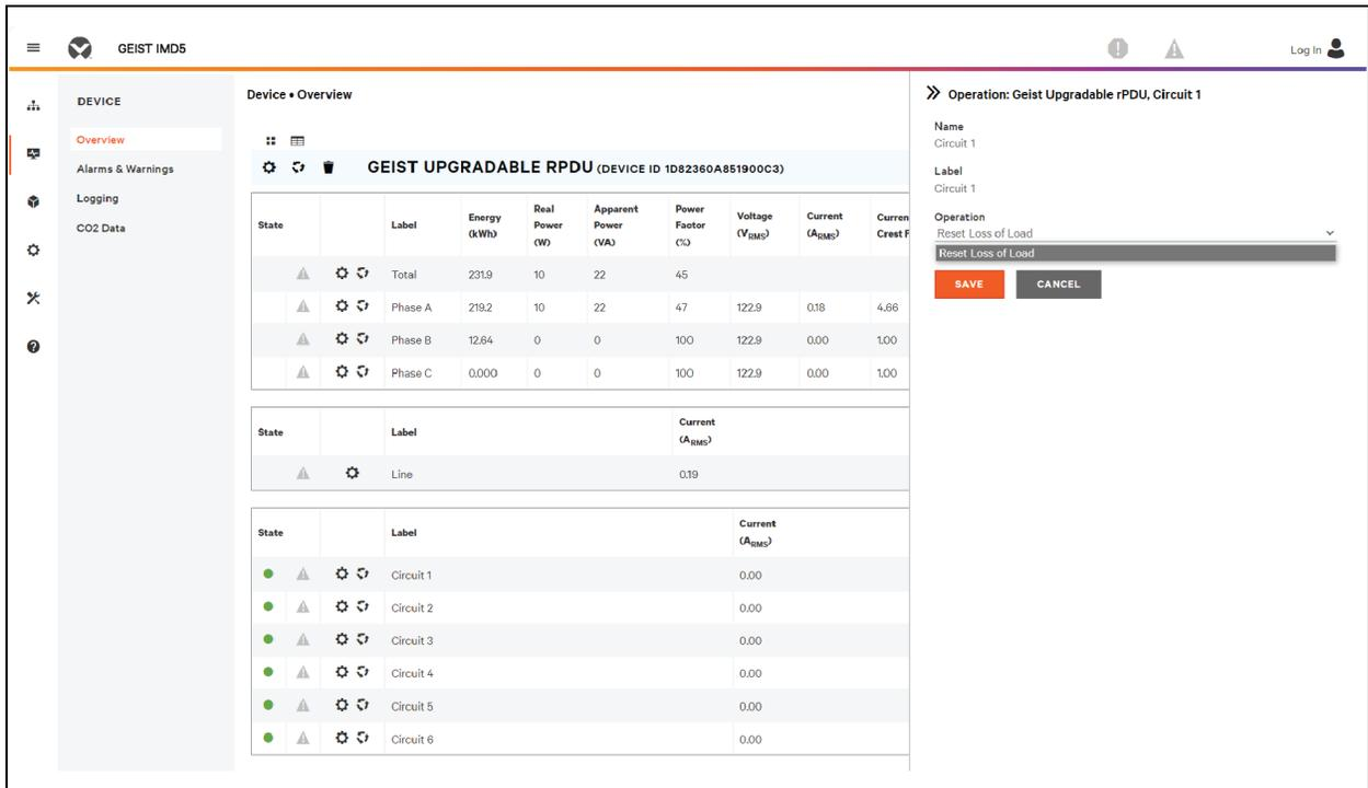
**OBSERVAÇÃO:** essa etapa é necessária quando o estado mostra um alarme de perda de carga e o problema foi resolvido. O alarme de perda de carga é acionado por uma queda repentina da corrente detectada pelo transdutor que faz a medição da corrente do disjuntor quando a operação se aproxima do limite de carga do circuito. Para as unidades horizontais atualizáveis com chaveamento, o alarme de perda de carga é também acionado pela perda de tensão do disjuntor (seja qual for a carga do circuito).
