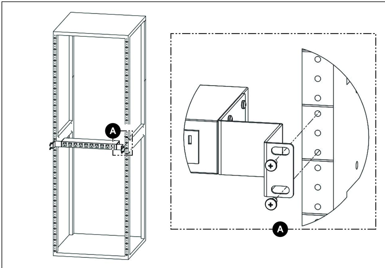
Figura 3.13 Suportes de montagem horizontal/no painel de 19" (polegadas)
