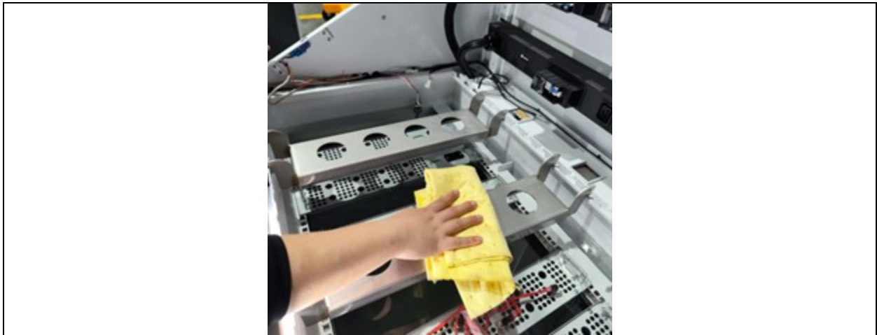
Şekil 7.10 Kılavuz rayının silinmesi
