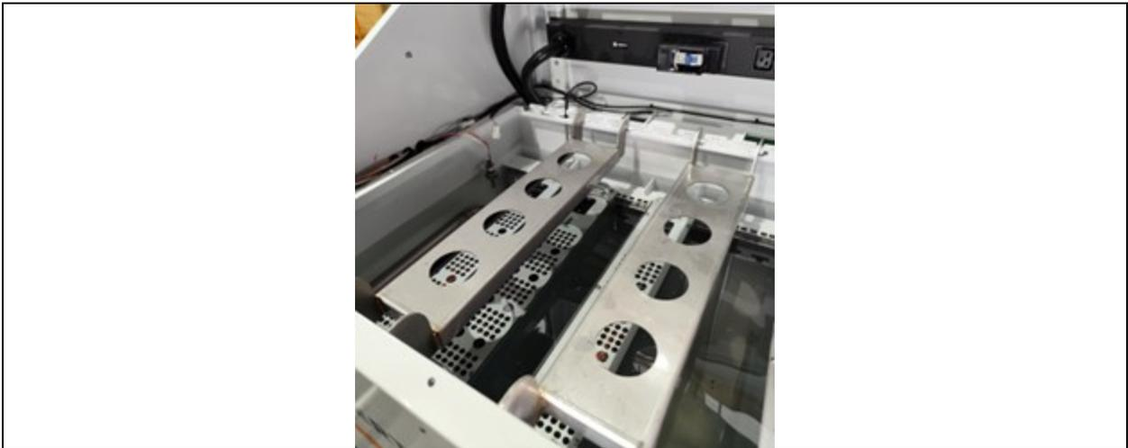
4. Cuelgue los cables de datos y de alimentación desenchufados con firmeza en los terminales para pasar cables que están dentro del tanque. Ajuste la longitud que cuelgan los cables, y compruebe que el refrigerante fluye de regreso al tanque, para evitar que el refrigerante gotee sobre la parte posterior del tanque y cause daños.
