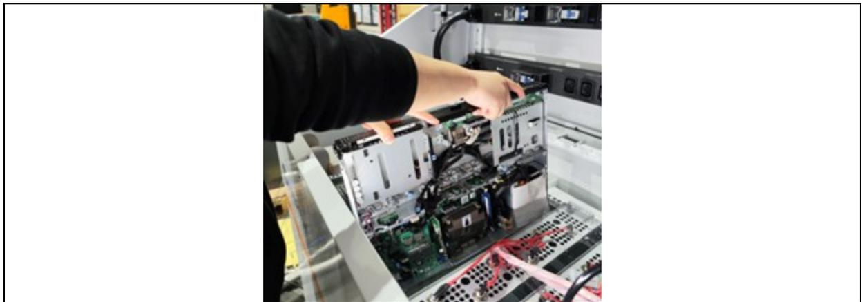
7. Después de elevar el servidor, asegúrese de que no está enganchado con cables o no entra en contacto con otros servidores.
