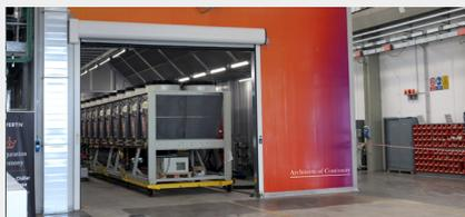
L'area di convalida del chiller freecooling è in grado di bilanciare un carico termico fino a 1600 kW con una temperatura dell'aria della camera compresa tra 20 °C e 50 °C e un setpoint dell'acqua del chiller compreso tra 5 °C e 20 °C.
