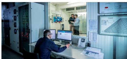
O laboratório de validação de investigação e desenvolvimento 1 foi concebida especificamente para testar unidades de chão e consegue equilibrar uma carga térmica de até 150 kW com uma temperatura do ar em câmara entre os 0 °C e os 60 °C.
