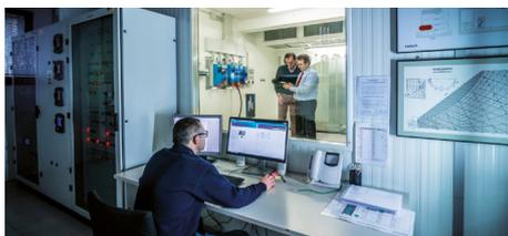
El laboratorio de I+D para validación n.º 1 está concebido específicamente para la ejecución de pruebas de unidades de montaje en el suelo y tiene capacidad para equilibrar una carga térmica de hasta 150 kW con una temperatura del aire de la cámara de entre 0 y 60 °C.
