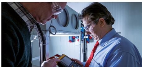
Concebida para aparelhos de ar condicionado que pertencem ao setor das telecomunicações, o laboratório de validação de investigação e desenvolvimento n.º 2 inclui duas câmaras de teste diferentes: uma que simula as condições ambiente internas de 0 °C a 60 °C e outra que simula as condições ambiente externas de -32 °C a 60 °C. Esta área de validação consegue equilibrar uma carga térmica de até 100 kW (50 kW em cada sala).
