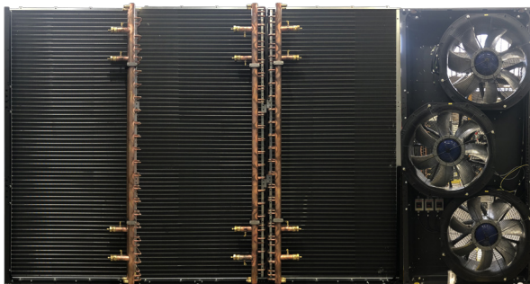
Bobinas de agua izquierda y central giradas 180°
