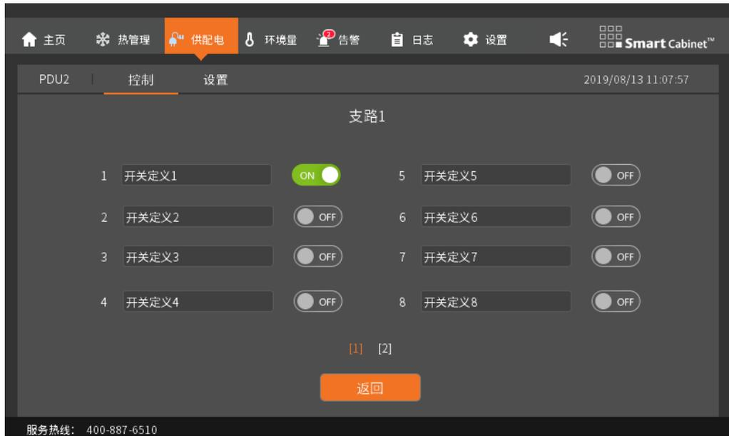
图3-9 PDU 控制页面
