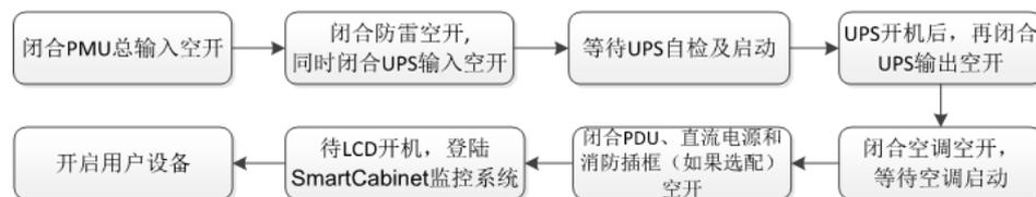
图2-31 SmartCabinet2-E 开机流程
