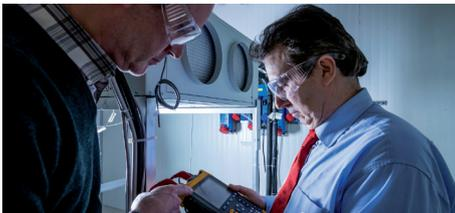
Das Validierungslabor 2 für Forschung und Entwicklung wurde für Klimageräte im Telekommunikationsbereich konzipiert. Es umfasst zwei verschiedene Testkammern: die eine davon simuliert interne Umgebungsbedingungen von 0 bis 60 °C, die andere externe Umgebungsbedingungen von -32 °C bis 60 °C. Dieser Validierungsbereich gleicht eine Wärmelast von bis zu 100 kW aus (50 kW in jedem Raum).
