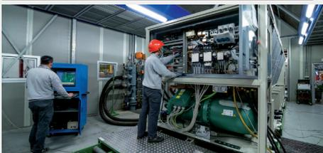
Der Prüfbereich für Kältemaschinen mit Freikühlung gleicht eine Wärmelast von bis zu 1600 kW mit einer Kammerlufttemperatur zwischen 20 und 50 °C und einem Kühlwassersollwert zwischen 5 und 20 °C aus.
