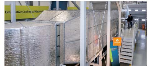
Gesonderter Bereich zum Testen der hochmodernen Liebert EFC, der hocheffizienten Freikühleinheit mit indirekter Verdunstungskühlung von Vertiv. Zu den Testparametern gehören IT-Lasten von bis zu 450 kW und ein Luftstrom von bis zu 120.000 m<sup>3</sup> pro Stunde bei jeder externen Umgebungstemperatur, die erforderlich ist, um typische Spitzenbedingungen in der EMEA-Region zu simulieren.
