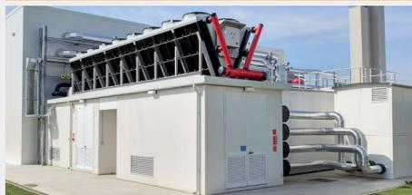
Dieses neu konzipierte Labor testet Geräte, einschließlich adiabatischer, mit einer Kühlleistung von bis zu 1,5 MW mit höchstmöglicher Genauigkeit in einem breiten Spektrum von Arbeitsbedingungen von -10 °C bis 55 °C.
