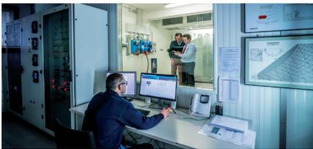
Das Validierungslabor 1 für Forschung und Entwicklung wurde eigens zum Testen von bodenmontierten Anlagen konzipiert. Es kann eine Wärmelast von bis zu 150 kW bei einer Kammerlufttemperatur zwischen 0 und 60 °C ausgleichen.
