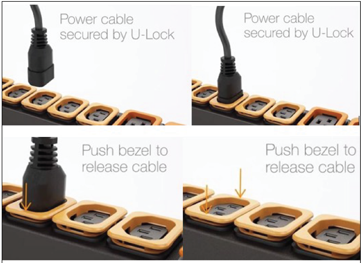
Figura 3.15 Funcionamiento de la retención del cable U-Lock
