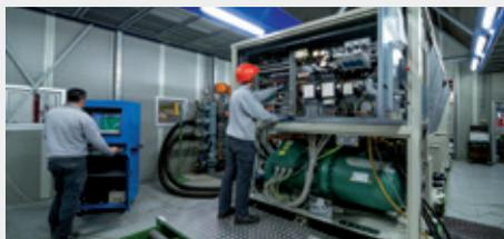
La zone de validation des groupes de production d'eau glacée freecooling est capable d'équilibrer une charge thermique allant jusqu'à 1 600 kW avec une température de l'air de la salle comprise entre 20 °C et 50 °C et un point de consigne d'eau du groupe de production d'eau glacée entre 5 °C et 20 °C.
