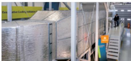
Espace dédié pour tester le Liebert EFC, l'unité de freecooling par évaporation indirecte à haut rendement de Vertiv, à la pointe de la technologie. Les paramètres de test intègrent des charges IT allant jusqu'à 450 kW et un débit d'air allant jusqu'à 120 000 m<sup>3</sup> par heure, quelle que soit la température ambiante extérieure requise pour simuler les conditions de pointe typiques que l'on peut rencontrer dans l'ensemble de la zone EMEA.
