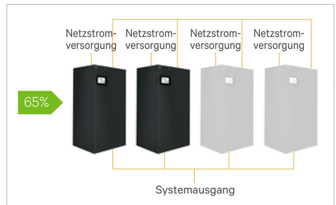
**Abbildung 2:** Liebert EXL mit Intelligenter Parallelschaltung: zwei 400-kVA-Blöcke bei jeweils 65% Last, Systemeffizienz ca. 96,7 %.
