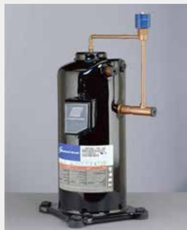
Copeland 數位渦卷壓縮機結合了渦卷壓縮機的高耐用性以及變容量調節製冷輸出技術，具有良好的適應性和可擴展性，針對逐漸變化的熱負荷自動調節，保證了資料中心的安全。
