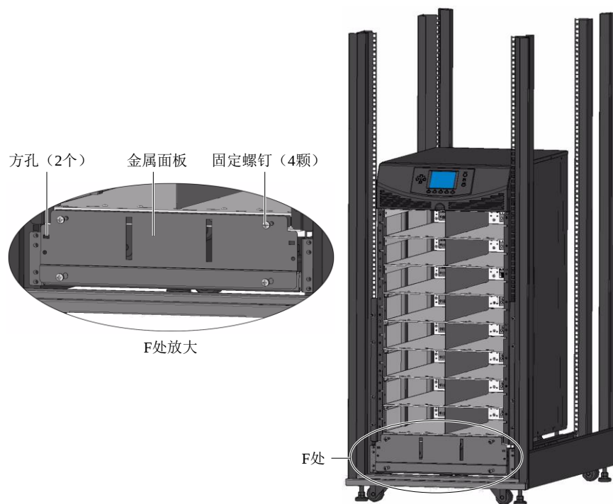
图2-13 金属面板安装
