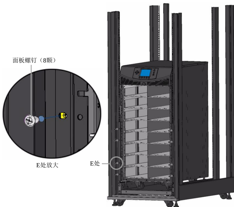
图2-12 固定 UPS 机柜
