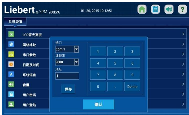
图 3-8 串口参数设置界面
