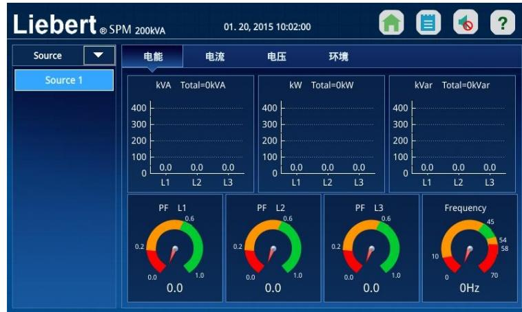
图 3-14 查询主路输入电能参数
