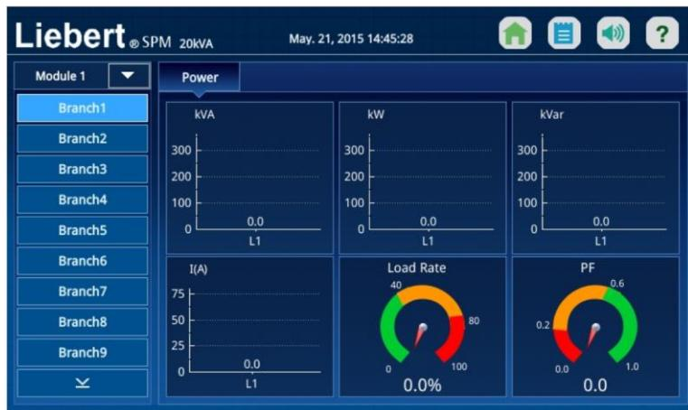
图 3-19 查询输出支路的电能参数
