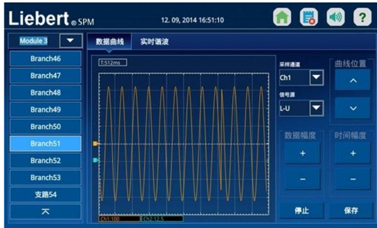
图 3-24 输出回路实时谐波含量显示
