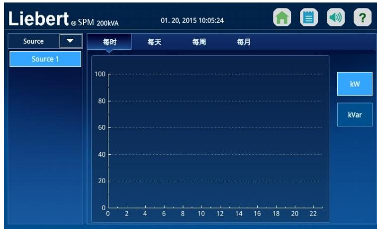
图 3-27 有功功率和无功功率使用数据查询
