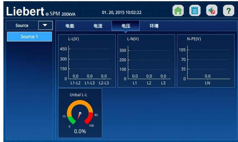
图 3-16 查询主路输入电压参数
