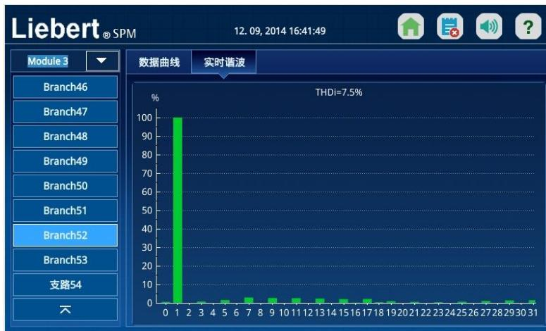
图 3-26 输出回路每次谐波含量显示
