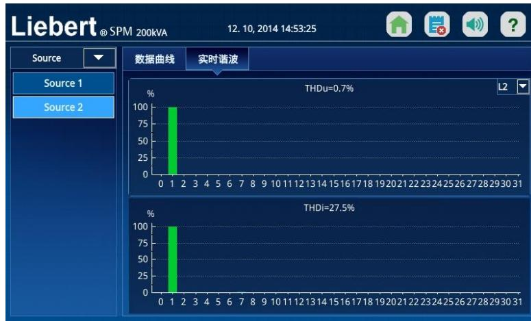
图 3-25 输入回路每次谐波含量显示
