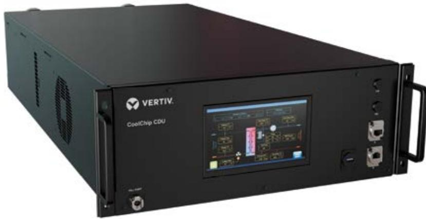
A unidade de distribuição de líquido (CDU) Vertiv™ CoolChip CDU 121 localizada no rack proporciona a separação efetiva entre o circuito de fluido da instalação e a rede de fluido secundária através de um trocador de calor de líquido para líquido para aplicações de resfriamento direto ao chip em um único rack.
