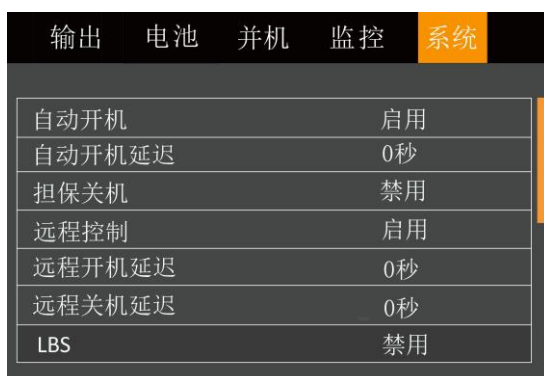
图3-10 双母线系统参数设置界面
