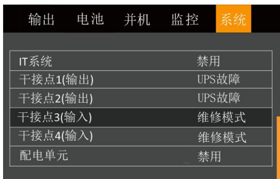
图5-7 确认干接点 3 为“维修模式”
