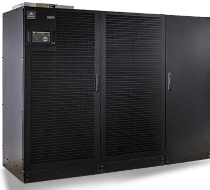
Este descritivo relata as características do sistema ininterrupto de energia (UPS) Liebert de **1.200KVA / 1.200KW**, trifásico 480V. Cada UPS é composto por retificador, inversor e chave estática individual. O UPS Liebert mantém automaticamente a energia AC dentro dos padrões de tolerância especificado, para a carga crítica, sem interrupções, durante falha ou anormalidades da rede.
