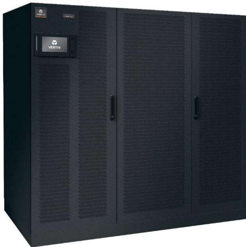
Este descritivo relata as características do sistema ininterrupto de energia (UPS) Liebert de **800KVA / 800KW**, trifásico 480V. Cada UPS é composto por retificador, inversor e chave estática individual. O UPS Liebert mantém automaticamente a energia AC dentro dos padrões de tolerância especificado, para a carga crítica, sem interrupções, durante falha ou anormalidades da rede.
