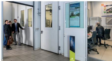
Quest'area è stata appositamente studiata per rispondere alla richiesta sempre maggiore di witness test e omologazione di prodotti speciali. Dotata di una sala climatica altamente automatizzata in grado di controbilanciare un carico termico fino a 200 kW, può simulare un ambiente di prova con escursione termica da 0°C a 60°C.
