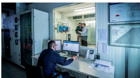
L'area di validazione Ricerca e Sviluppo n. 1 è progettata specificamente per testare le unità montate a pavimento ed è in grado di controbilanciare un carico termico fino a 150 kW con una temperatura dell'aria della camera compresa tra 0°C e 60°C.
