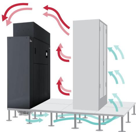
Por exemplo, digamos que a temperatura do ar frio quando ele sai da unidade de tratamento de ar e entra no data center seja de 24°C (75°F). Quando ele retorna do data center, após realizar seu trabalho de resfriar os servidores, switches e outros equipamentos de TI, a temperatura do ar é agora de 35°C (95°F). Isto é um Delta T de 11°C (20°F) – uma meta de projeto bastante comum para data centers.
