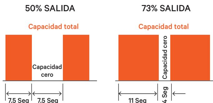
Fuente: Comprensión de la modulación del compresor en el aire Aplicación del acondicionamiento
