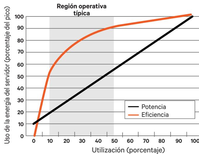
Fuente: Hölzle, 2017. Nota: En un servidor más proporcional a la energía (línea roja) la eficiencia energética es más del 80% del valor máximo para niveles de utilización del 30% o más, permaneciendo la eficiencia por encima del 50% para niveles de utilización tan bajos como el 10%.
