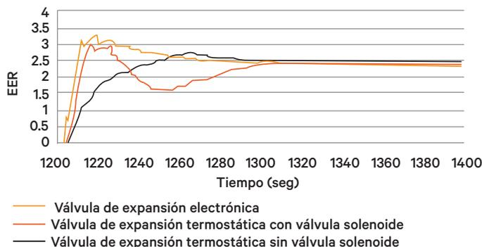
*Nota: Los valores medidos durante las pruebas con la EEV son siempre más altos que los valores EER medidos con la TXV, con o sin válvula solenoide. Esta mayor eficiencia energética está garantizada por la capacidad de la EEV para optimizar el control del flujo de refrigerante en el evaporador, limitando así la entrega del líquido en el compresor.*
