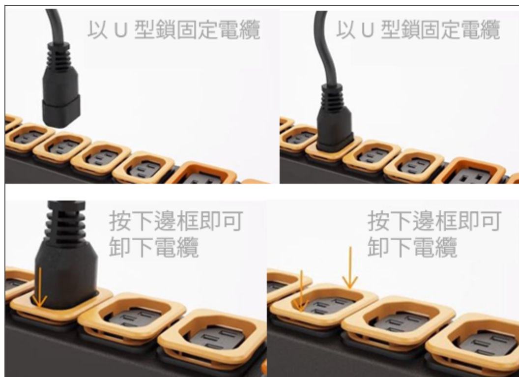
圖 2.15 U 型鎖電源線固定操作
