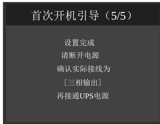
图6 设置完成 (16kVA/20kVA)
