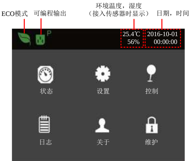
图4-2 LCD 显示屏示意图
