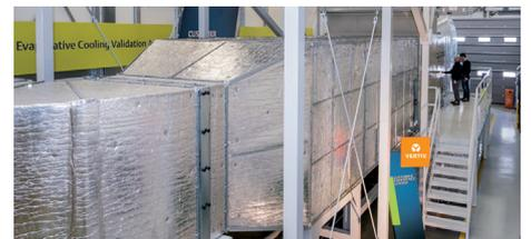
Espace dédié pour tester le Liebert EFC, l'unité de freecooling par évaporation indirecte à haute efficacité de Vertiv. Les paramètres de test intègrent des charges IT allant jusqu'à 450 kW et un débit d'air allant jusqu'à 120 000 m<sup>3</sup> par heure, quelle que soit la température ambiante extérieure requise pour simuler les conditions de pointe typiques que l'on peut rencontrer dans l'ensemble de la zone EMEA.
