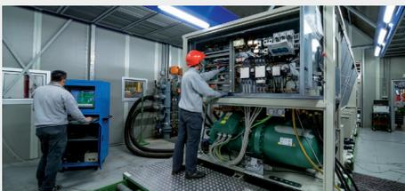
La zone de validation des groupes de production d'eau glacée freecooling est capable d'équilibrer une charge thermique allant jusqu'à 1 600 kW avec une température d'air de la salle comprise entre 20 °C et 50 °C et un point de consigne d'eau du groupe de production d'eau glacée entre 5 °C et 20 °C.
