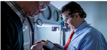
Conçu pour des climatiseurs du secteur des télécoms, le laboratoire de validation de Recherche et Développement n°2 regroupe deux espaces de tests distincts : l'un simule des conditions ambiantes internes comprises entre 0 °C et 60 °C et l'autre des conditions ambiantes externes allant de -32 °C à 60 °C. Cette zone de validation peut équilibrer une charge thermique jusqu'à 100 kW (50 kW dans chaque salle).
