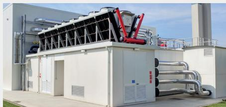
Ce laboratoire récemment conçu peut tester des unités avec des puissances frigorifiques allant jusqu'à 1,5 MW avec une précision de pointe dans une large variété de conditions opérationnelles, de -10 °C à +55 °C, idem pour des unités adiabatiques.
